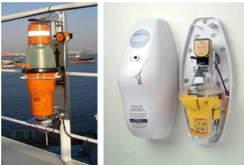
Slika 24. Tron S - VDR CAPSULE montiran na ogradu iznad kormilarnice i Mc Murdo E5 SMARTFIND sa zaštitnim kućištem (406 MHz EPIRB). 24
