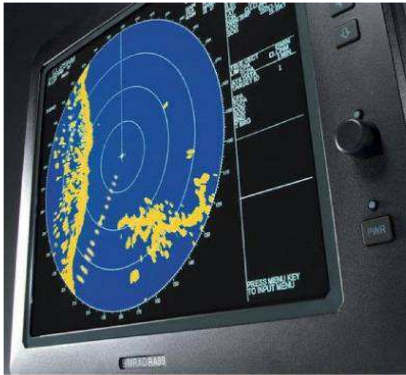
Slika 26. Aktivirani SART na radarskom ekranu. 26
