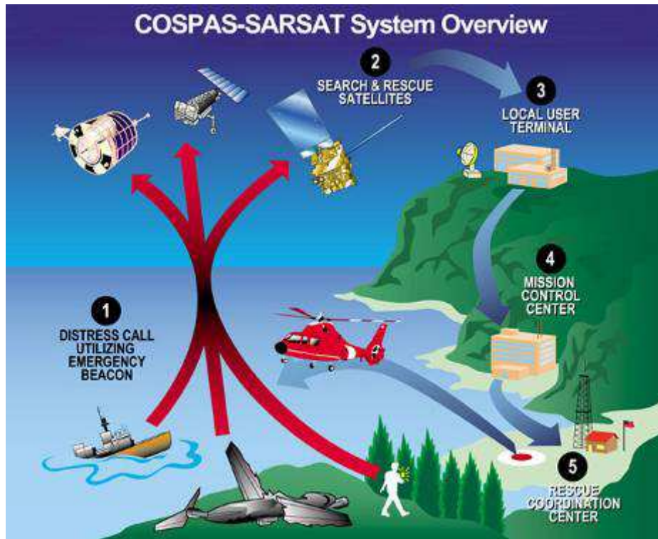
Slika 2.20. Osnovni koncept COSPAS/SARSAT sistema. 19
