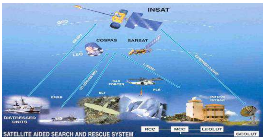
Slika 21. Prikazuje emitovanje signala između radio plutače, satelita i LUT - a. 20
