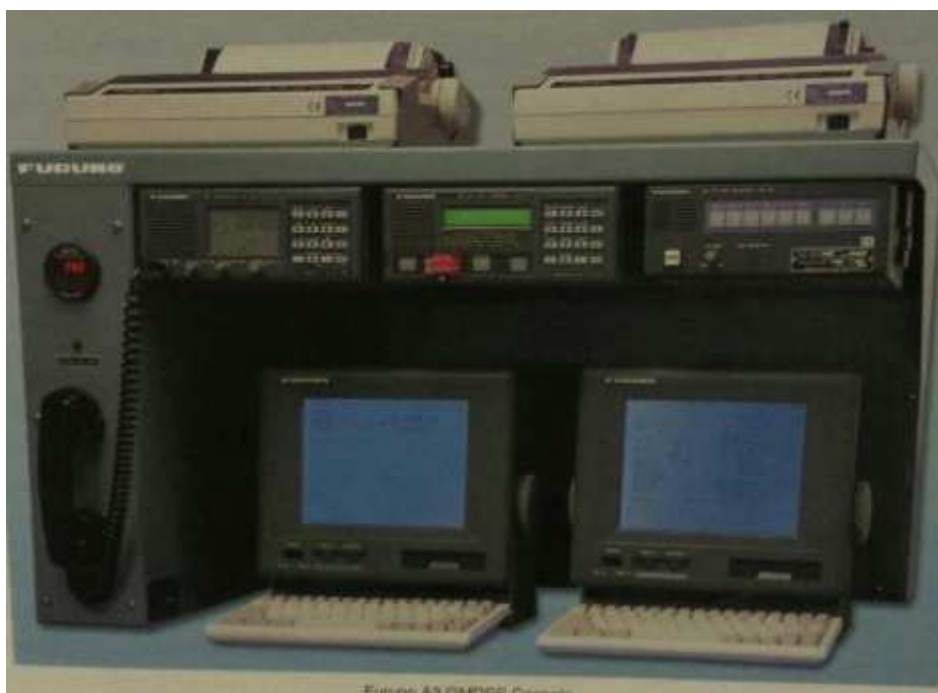
Slika 6. GMDSS oprema za zonu A3 (Furuno A3 GMDSS Console) 6
