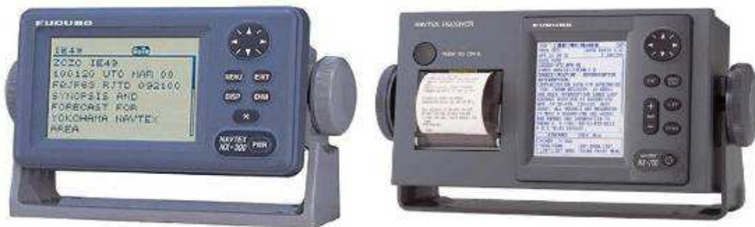
Slika 8. NAVTEX uređaj (Furuno NX - 300 (bez pisača) i Furuno NX - 700A (sa pisačem) NAVTEX prijemnici 8
